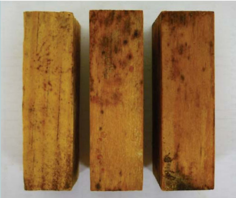
Abb. 2: Seitenansicht Variante MHVS nach Prüfung gegen Coniophora puteana auf Kiefer, unbehandelte Referenz, ohne Auswaschung, mit Auswaschung (v.l.n.r.)
