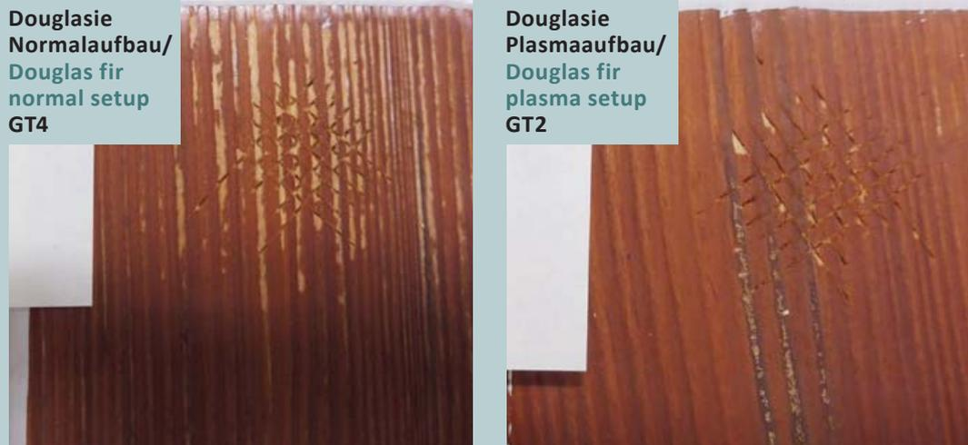
Abb. 1: Vergleich der Gitterschnittkennwerte der mit einer Lasur beschichteten Douglasie im Normalaufbau (links) und mit Plasmagrundierung (rechts) nach künstlicher Belichtung gemäß EN 927-6:2006
