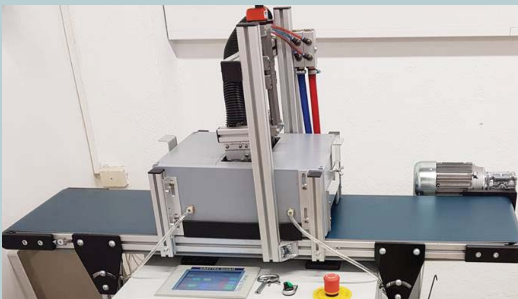
Abb. 1: UV-LED-Laboranlage mit 365 nm und 395 nm Strahlern in Inertisierkammer
