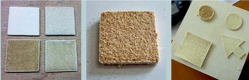
Abb. 3: Helligkeitsabgestufte Druckbilder (links), poröses Druckerzeugnis unter Nutzung groben Holzmehls (Mitte), ansprechende Konturschärfe (rechts)
