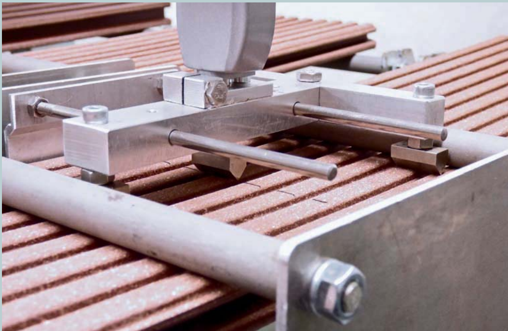
Abb. 1: Darstellung von schneidenförmigen Füßen an einer Messbrücke zur Bestimmung der Durchbiegung an einer rauhen, unebenen und profilierten WPC-Diele
