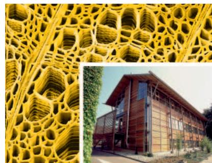
**Titelmotiv****Großes Bild:***REM-Aufnahme eines Querschnittes von Linde.**Foto: E. Bäucker, TU Dresden***Kleines Bild:***Das Foto ist das Bürogebäude der Firma Derix Holzleimbau in Niederkrüchten. Das Skelett umfasst alle tragenden Teile des Bauwerks. Der mehrschossige Holzskelettbau erhielt 2000 den Holzbaupreis Nordrhein-Westfalen.**Foto: Derix***holztechnologie****Kontakt zum Verlag****Chefredaktion**Dr. rer. silv. Siegfried Tzschlerich
