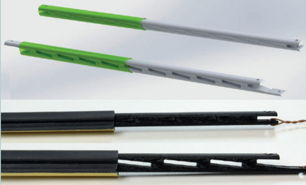
Abb. 2: Gegeneinander verschiebbare Stränge mit Sägezahnstruktur; 3D-Entwurf und exemplarische Umsetzung Fig. 2: Saw-toothed webs that can be shifted against each other; 3D design and exemplary implementation
