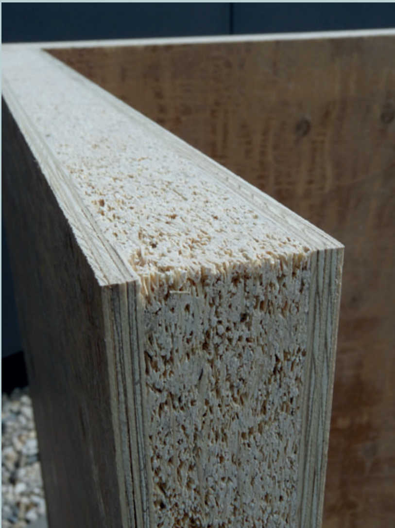
Abb. 1: HZH-Wandsystem – Decklagen aus zementgebundenem Sperrholz und Mittellage aus leichter Spanplatte
