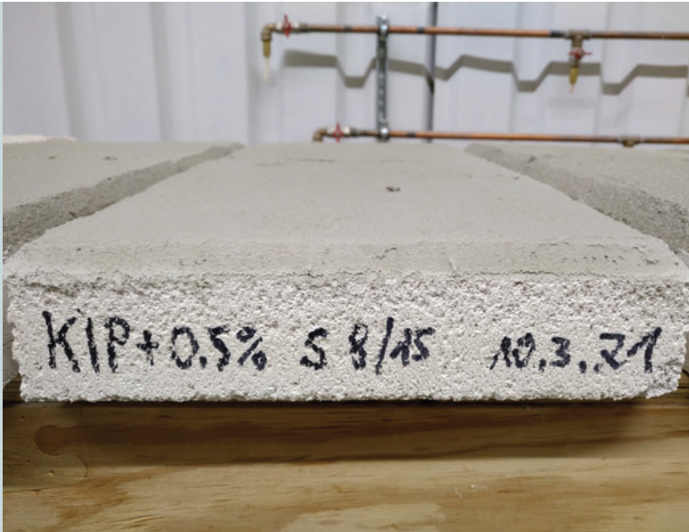
Abb: 1: Leichter Kalk-Innenputz mit 0,5 % Holzspänen auf Gasbeton
