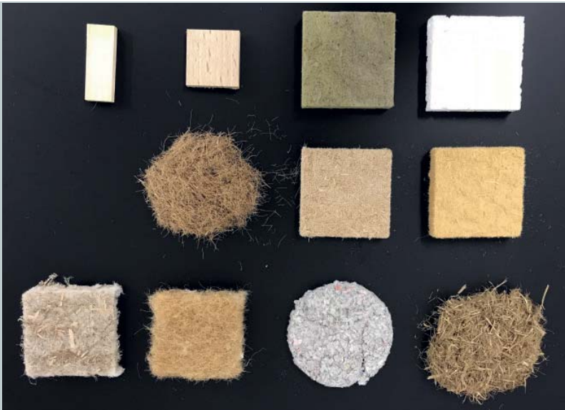
Abb. 2: Dämmstoffproben für die Schimmelpilzprüfung
