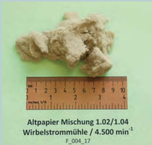
Abb. 1: Altpapierfaserstoff nach Aufschluss in Horizontal-Wirbelstrommühle (4.500 min -1 )
