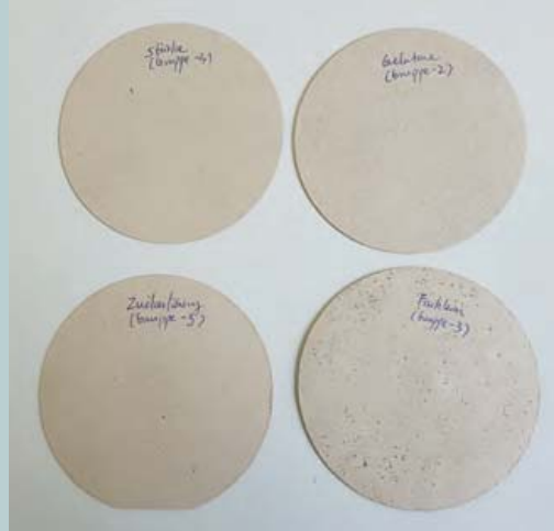
Abb. 3: Hergestellte Trockenkartone unter Variation des Klebstoffes
