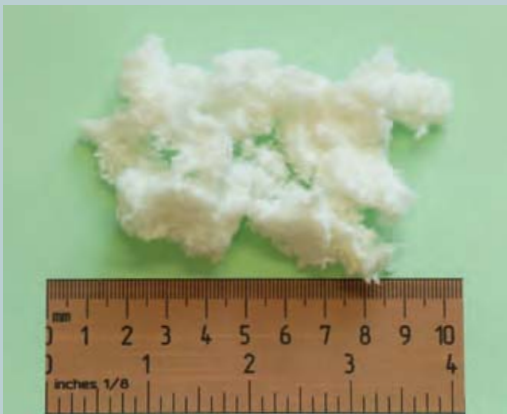
Abb. 1: Faserstoff aus Etikettenträgerpapier ( 6.000 \text{ min}^{-1} ) Fig. 1: Fibre material from label backing paper ( 6.000 \text{ min}^{-1} )
