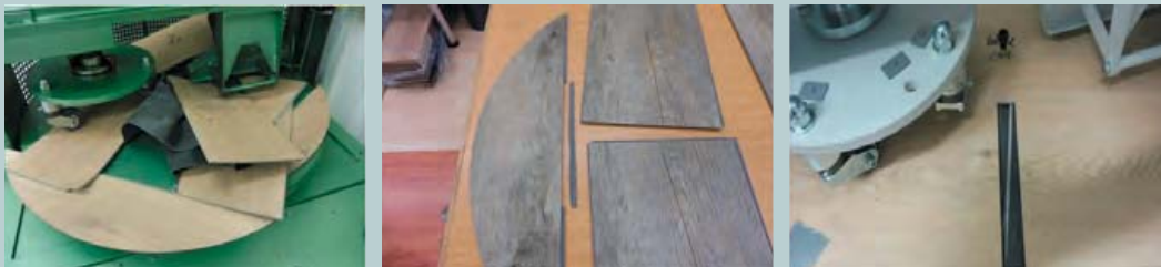
Abb. 1: Stuhlrollentest eines MMF-Produktes mit verschiedenen Verlegeunterlagen; weich und hart mit 3 Rollen (links, mittig) und 5 Rollen (rechts)
