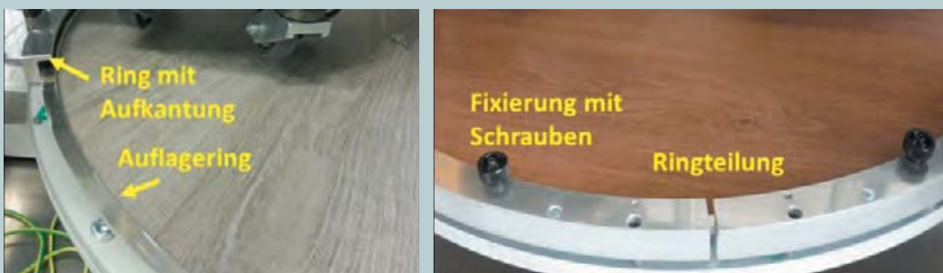
Abb. 2: Probenhalterung zur Begrenzung des Prüfkörpers bei Stuhlrollentest
