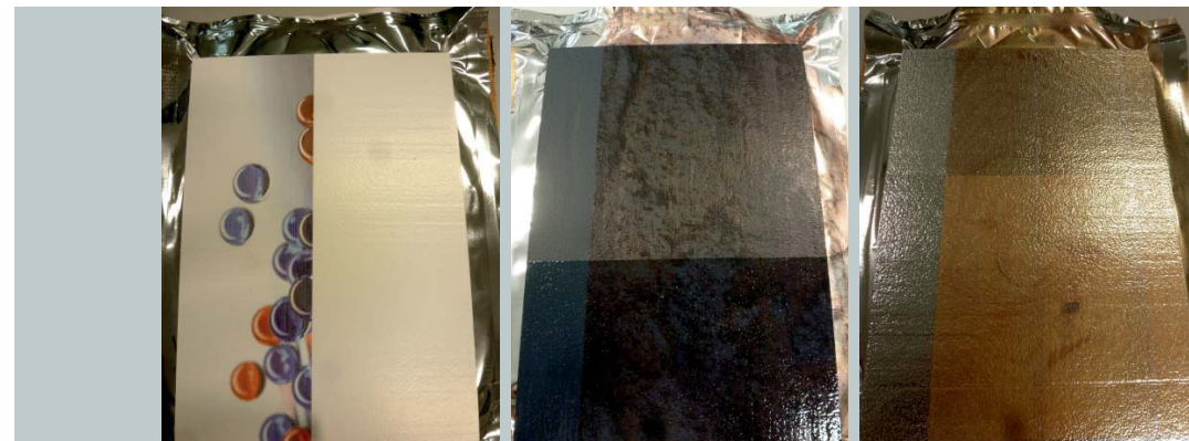
Abb. 1: Digitaldruckvarianten auf verschiedenen Grundierungen: links auf weiß pigmentierter dauerelastischer Acrylat-Copolymerisat-Dispersion, mittig auf schiefergrauem Kunststoffhaftprimer und rechts auf angeliertem UV-Lack
