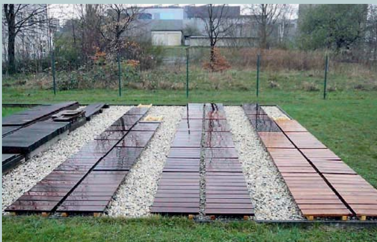
Abb. 1: TMT-Varianten in Bewitterung auf dem IHD-Freilandversuchsfeld (regennass)
