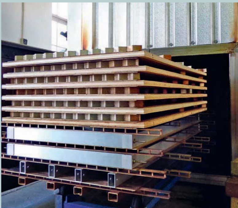
Abb. 1: Thermische Modifikation von Massivholzplatten im Labor-Thermoofen des IHD
