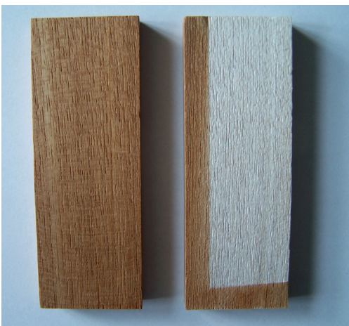
Teak nativ vor/nach 500 h Belichtung im Xenon-Testgerät
