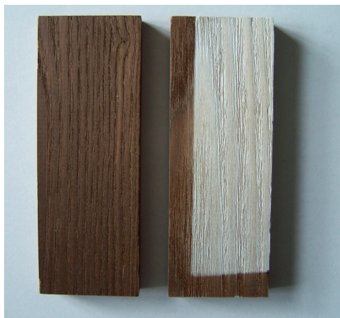
TMT Esche 200 vor/nach 500 h Belichtung im Xenon-Testgerät
