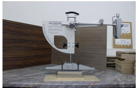
*Pendelprüfung zur Bestimmung der Rutschhemmung*
