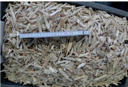
Altholz zur Verwendung für die Zerfaserung (aufgereinigt und nachzerkleinert)
