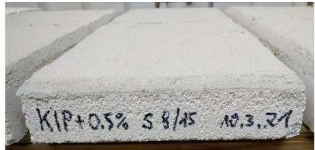
Leichter Kalk-Innenputz mit Holzspänen auf Gasbeton
