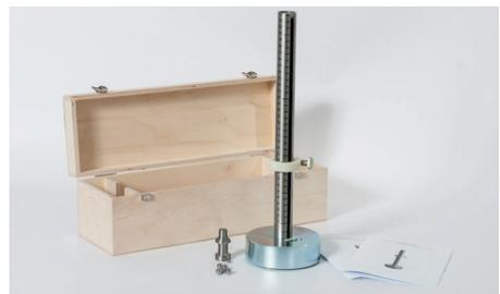
Stoßfestigkeitsgerät nach EN 17368 für Laminatfußböden
